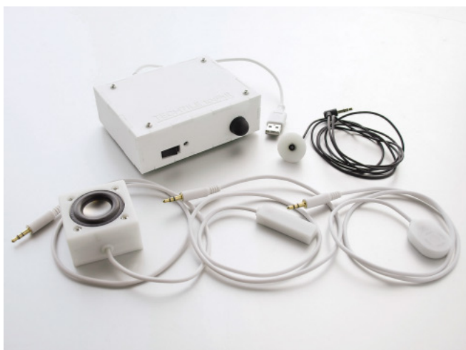
触感を触覚振動によって提供する TECHTILE toolkit。動画コンテンツと組み合わせて使用することで、動画内の物体に触れている感覚や実感を体験可能になる
