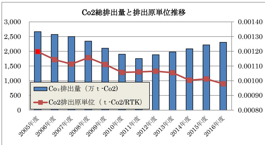
・有償トンキロの増加に伴い、Co<sub>2</sub> 総排出量が増加しているが、燃費効率の良い航空機材への入れ替えと、需要に合わせた航空機材の適正化等を進化させる事で、排出原単位は前年レベルより低下している。
