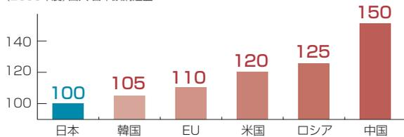
■セメントの中間製品(クリンカ)1トンを作るのに必要なエネルギー指数比較(2000年度) 出典:Battelle研究所
