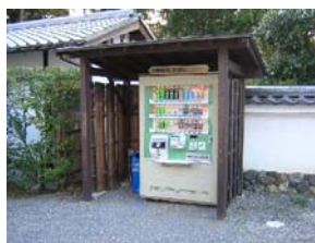
茶配合樹脂パネルを 貼付した自動販売機
