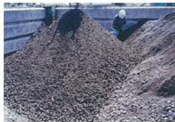
配電工事で発生する老朽化した廃コンクリート 柱は切断・粉砕の過程を経て土木建築物の基礎 材としてリサイクルされます。
