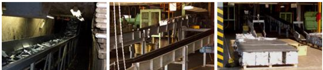
(d) 金属端材の再生利用例 プレス工場で裁断したパネルの端材を金属原料として再生利用
