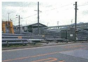
廃コンクリート柱を骨材としても使用し、再 生コンクリート柱とすることで天然骨材の使 用量削減に取り組んでいます。
