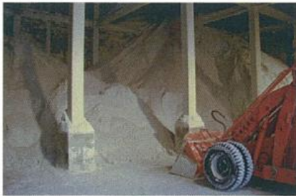
火力発電所の排煙脱硫装置から 取り出した石膏（副生品） （排煙中の硫黄酸化物を除去するため、石灰と 硫黄酸化物を反応させて石膏として取り出します。）
