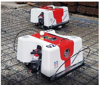
鉄筋結束ロボット（トモロボ）
