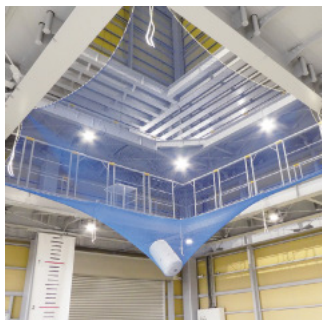
水平安全ネット落下試験
