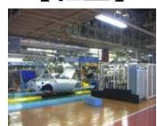
エンシ`ン,ミッション,シート, 計器類,ハ`ンパー, 窓ガラスなど内外装 部品を取り付ける。
