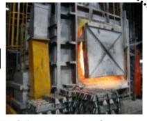
鉄やアルミを溶解して型に流し込み シリンダーブロックやシリンダーヘットなどの ・部品の成形を行う。
