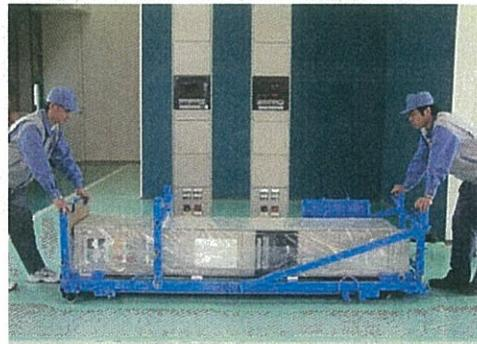
発電所や変電所に配電盤を運搬する際の梱包材に代えて、「配電盤運搬用据付コンテナ」を開発し木枠の削減に取り組んでいます。
