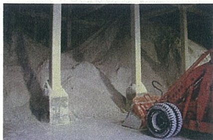
火力発電所の排煙脱硫装置から 取り出した石膏（副生品）
