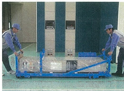
発電所や変電所に配電盤を運搬する際の梱包材に代えて、「配電盤運搬用据付コンテナ」を開発し木枠の削減に取り組んでいます。
