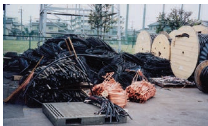
古くなって取り替えた銅電線やアルミ電線を 切断、破碎し、材質ごとに分別します。
