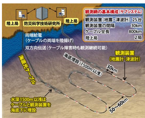
図4 S-NETの観測システム基本構成
