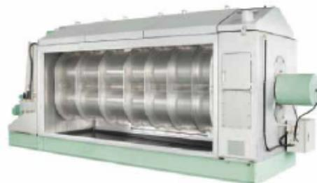
Pic.20 高効率型二軸スクリーンプレス脱水機
