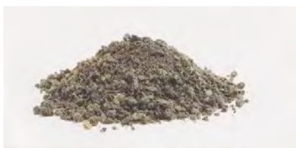
石炭火力発電所から発生した石炭灰 （写真はクリンカアッシュ。クリンカアッシュは、 ボイラ底部に落下した灰の塊を粉砕したもの。）
