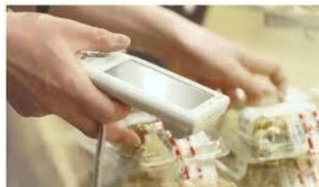
（AIカカク）端末で商品をスキャンし、在庫数を入力すると最適な割引率を提示。端末を通じてバーコードプリンターに出力された値引きシールを印刷して商品に貼る。
