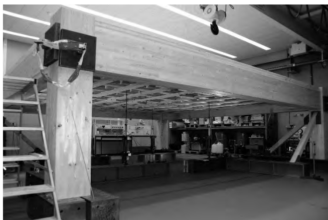
図表 4－9 チューリッヒでのポストテンション構法 （左：研究室での実験、右：施工現場風景）
