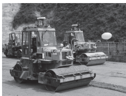
自動振動ローラ: 転圧作業の自動化
