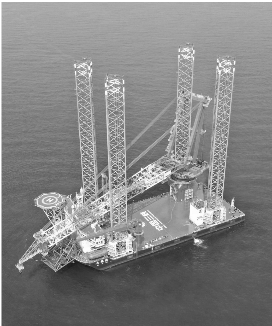
図表 8-3 2022 年 9 月に引き渡された移動式風力発電プラットフォーム「白鶴灘」
