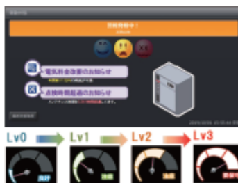
Fig.30 遠隔監視FitLive画面、吸込みフィルター目詰り表示
