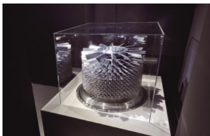
原子力研究向けに開発した世界最大級ターボ分子ポンプの回転体
