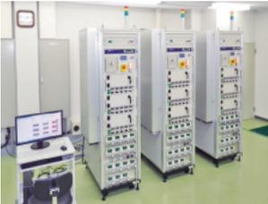
多摩川電子開発の半導体信頼性評価試験装置
