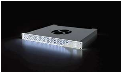
IDEMIA HSM：従来の一体型ではなく、複数のセキュアエレメントを組み合わせた分散型構造
