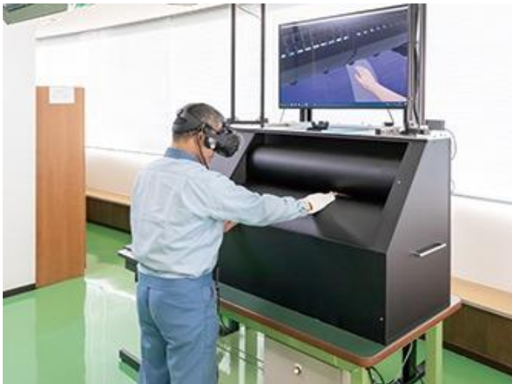
オフセット輪転機巻き込まれ体感機に VR 映像を組み合わせたもの。体験者は手袋を装着し、映像と連動して手がローラーに巻き込まれることを疑似体験できる
