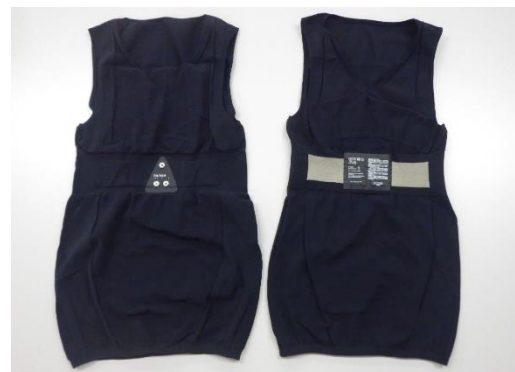
タンクトップシャツ型ウェアラブル端末「hamon」の写真。生体情報を収集するためのトランスミッターがついており、作業員はこれをインナーシャツとして着用。より良い着心地と精度の高いデータ収集を目指し、現在も改良が重ねられている。
