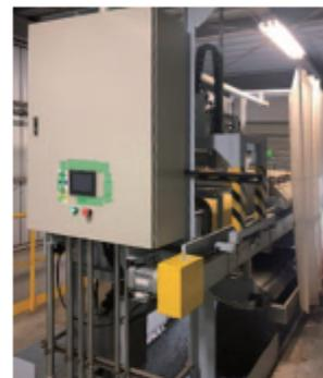
FIG.3 フィルタープレス式自動脱水装置
