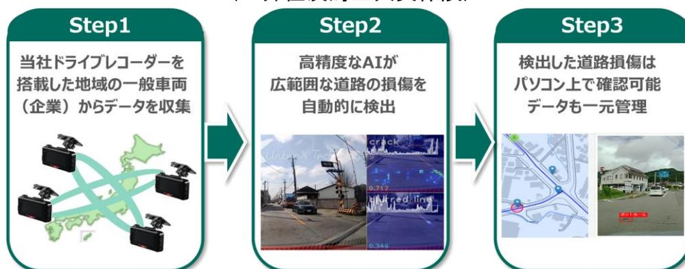
民間企業車両等に搭載されたドライブレコーダー（全国約8万台）が走行時に取得したデータを人工知能技術により解析し、道路の損傷情報を広範囲に、また自動的に検出する。道路管理者である国や地方自治体の点検・管理業務を効率化しながら、損傷を早期に発見し、道路の品質を維持することを通じて交通事故を削減することにつながる。
