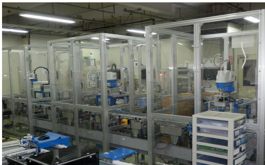
ロボット仕分け製品仕上げライン
